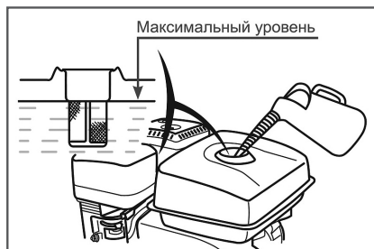
Рис. 11 Максимальный уровень топлива в топливном баке
